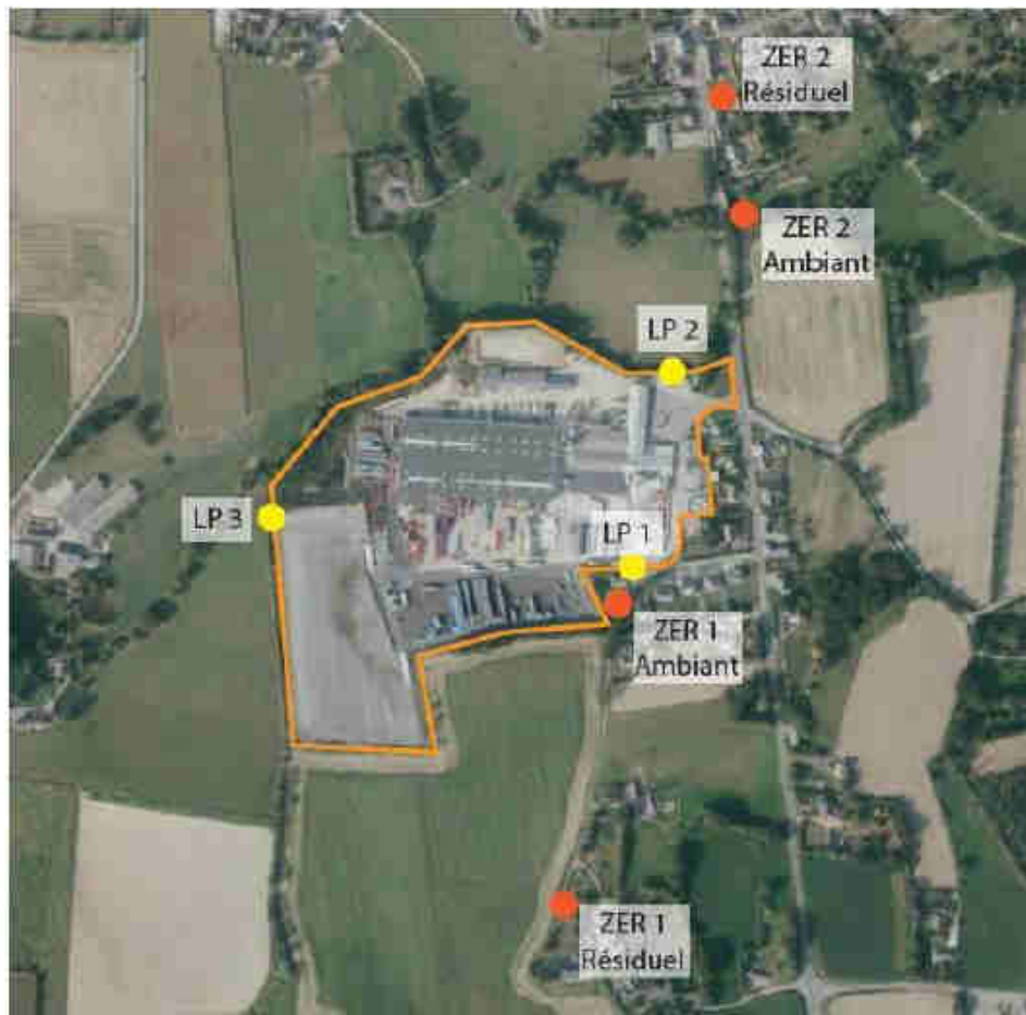
Figure 35 : Implantation des points de mesures
