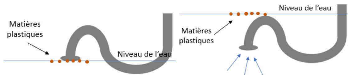
Figure 87 : Système d'évacuation des eaux pluviales (Source : GES)
